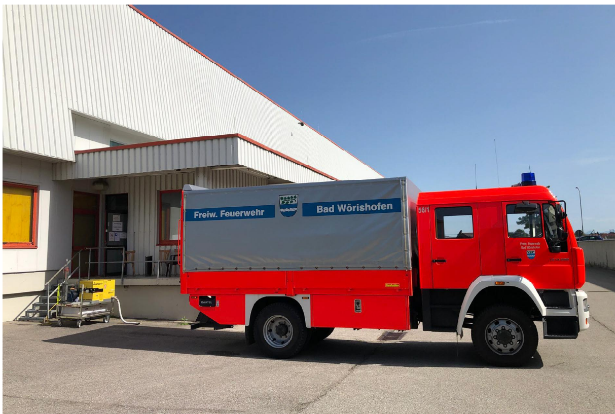
Stromausfall in weiten Teilen von Bad Wörishofen. Stromeinspeisung mit einem Stromerzeuger im Impfzentrum Bad Wörishofen, damit die Kühlketten des Impfstoffes nicht unterbrochen werden.
