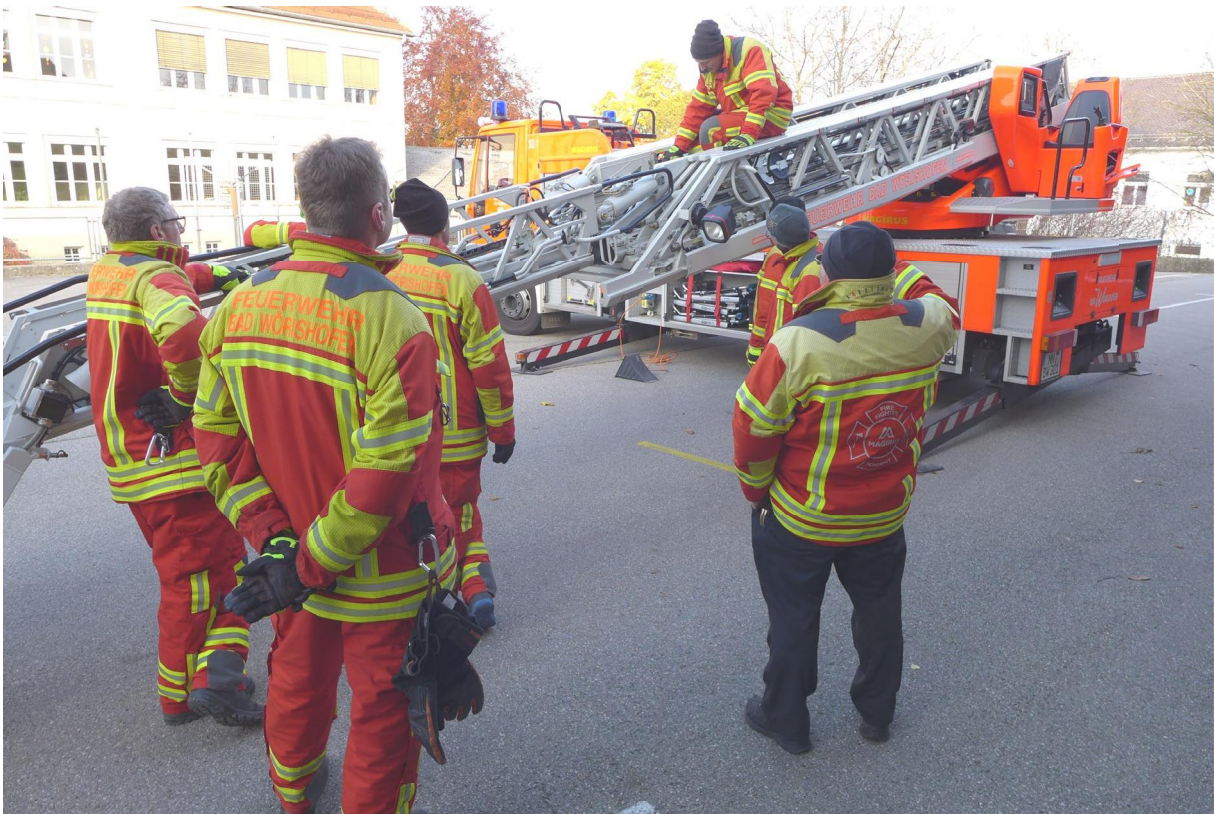
Auffrischungseinweisung für die Drehleitermaschinenisten in die Drehleitertechnik (u. a. Notbetrieb und Verbindungsmittel Tragenrettung) durch die Fa. Magirus aus Ulm.
