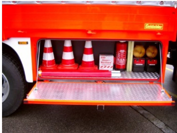
Staukasten rechts: Ausrüstung zur Verkehrsabsicherung (Verkehrsleitkegel, 2 Euro-Blitz, 2 Faltschilder)
