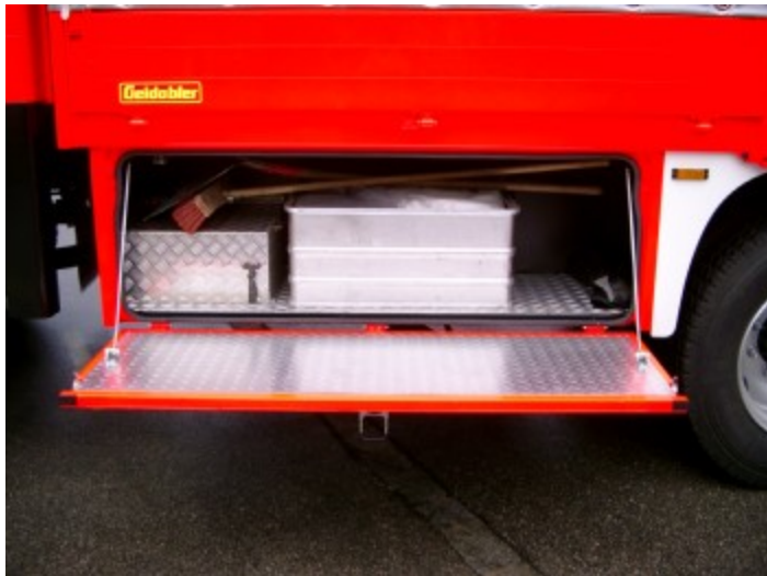
Staukasten links: Ausrüstung zur Beseitigung von Ölspuren (Ölbindemittel, Besen und Schaufeln)
